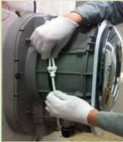
[Anschluss des Einlassschlauchs]
